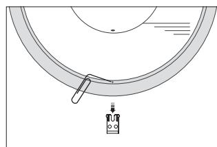
*En papirclips kan bruges til at afmontere højttalerfronten.*
