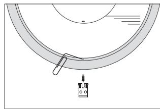
Um die Lautsprecherabdeckung zu entfernen, kann eine Büroklammer verwendet werden.
